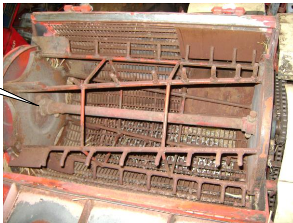
Hình 2: Vị trí cải tiến trục buồng đập
