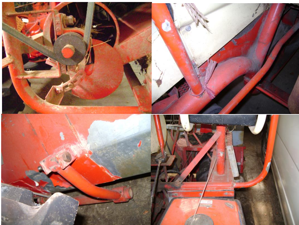
Hình 5: các chi tiết uốn trên thân máy
